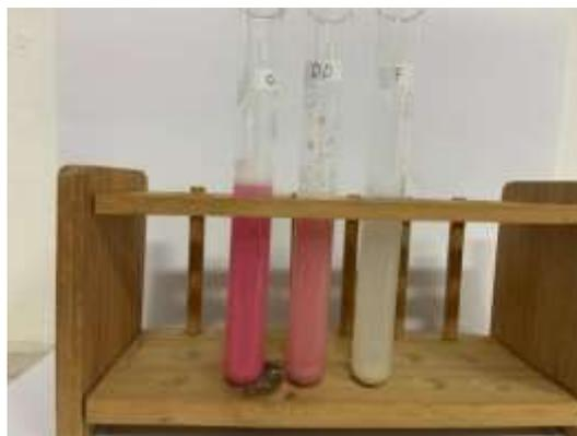
**Gambar 1.** Hasil Pengujian Sampel Bakso Menggunakan Kit Formalin (O dan DD) positif formalin ditandai dengan perubahan warna larutan menjadi merah muda (F) negatif formalin ditandai dengan tidak ada perubahan pada warna sampel.
