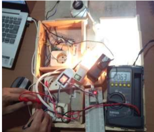
Gambar 9. Pengukuran Arus Pada Beban Dua Lampu dan Satu Kipas Angin
