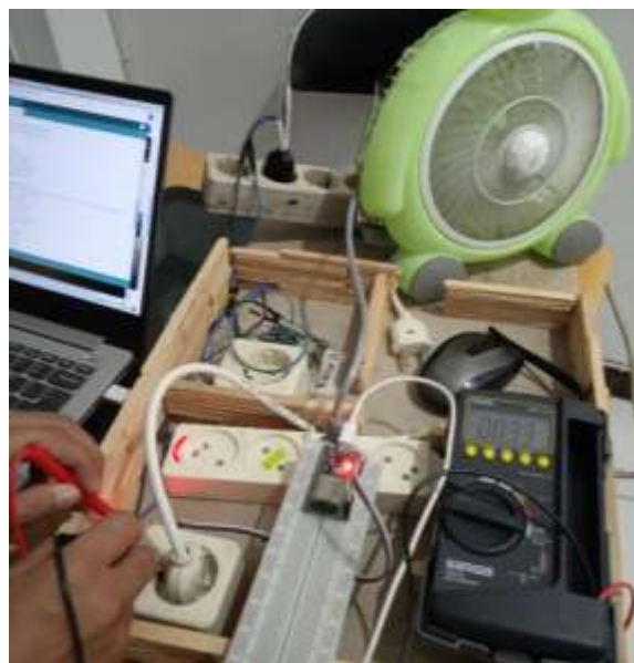
Gambar 8. Pengukuran Arus Pada Beban Kipas Angin
