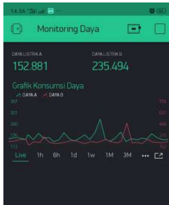
Gambar 12. Hasil Implementasi Antarmuka Blynk Untuk Monitoring Konsumsi Daya Listrik Dengan Beban Satu Pengisi Daya Komputer Jinjing Pada Kamar A dan Satu Lampu Pada Kamar B
