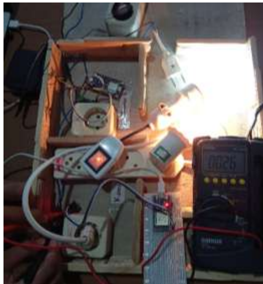
Gambar 7. Pengukuran Arus Pada Beban Dua Lampu
