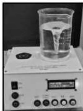
Gambar 5. Alat Pengaduk Magnetik Hasil Perancangan
