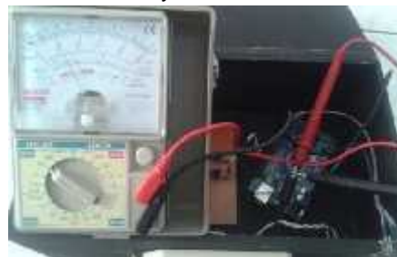
Gambar 6. Pengujian Catu Daya Dengan Multitester
