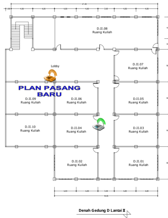
Gambar 2. Denah Lokasi Pemasangan Access Point
