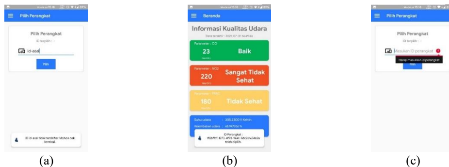
Gambar 12. Hasil pengujian fungsi memasukkan ID perangkat (a) Tampilan informasi ID perangkat tidak terdaftar, (b) Tampilan informasi ID perangkat terdaftar, (c) Tampilan kolom ID perangkat tidak boleh kosong
