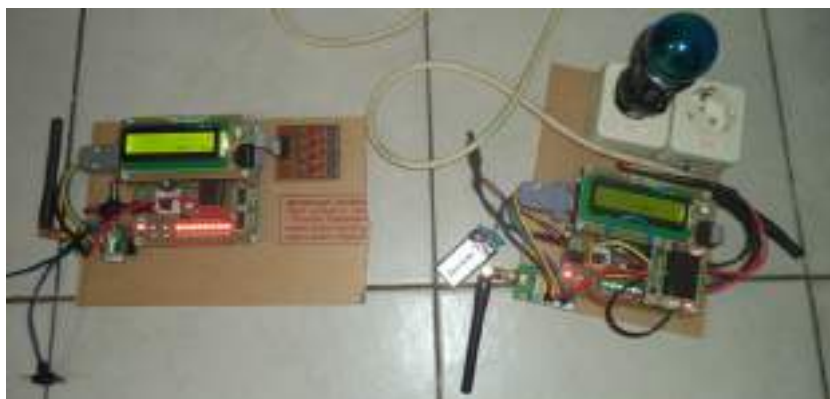
Gambar 6. Rangkaian dengan posisi Lampu Tidak Menyala (OFF)
