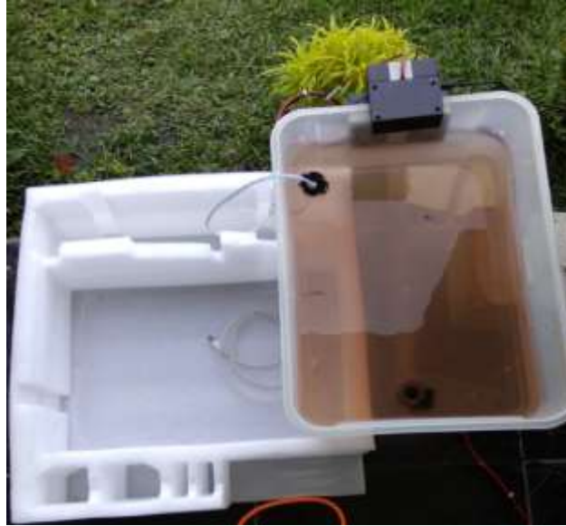
Gambar 7. Kolam Ikan yang dilengkapi dengan Ultrasonik dan Turbidty Sensor
