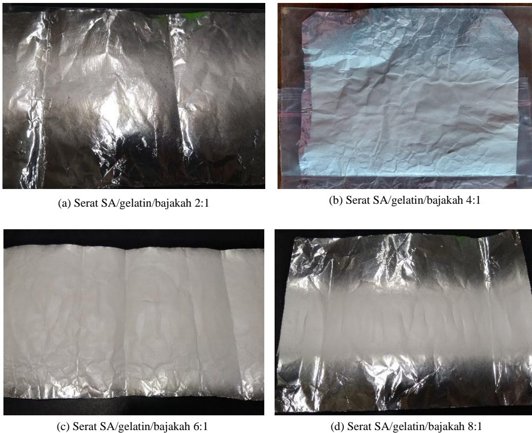
Gambar 4. Bentuk lembaran serat SA/gelatin/bajakah hasil electrospinning dengan variasi perbandingan volume larutan SA/gelatin terhadap larutan ekstrak bajakah.
