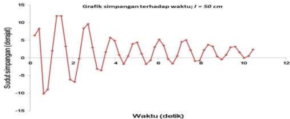
Gambar 6. Hubungan sudut simpangan dengan waktu untuk l = 50 \text{ cm} .
