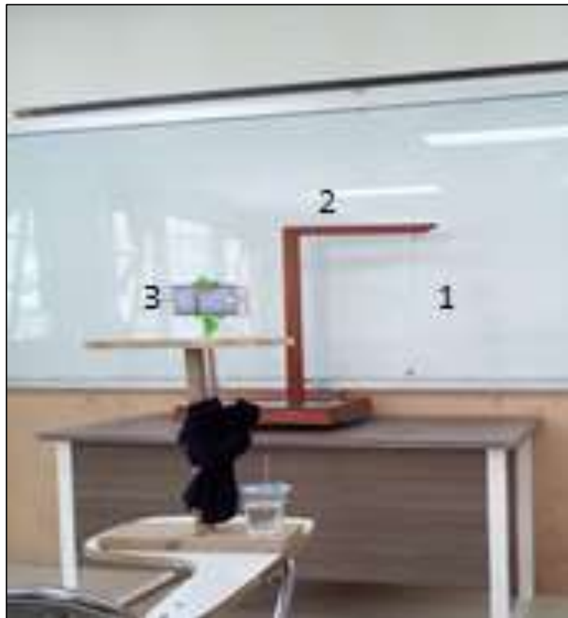
Gambar 1. Rangkaian alat perekaman gerak bandul sederhana. (1) bandul dengan beban siap untuk diberi simpangan, (2) statik untuk meletakkan bandul, dan (3) kamera.
