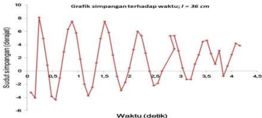
Gambar 3. Hubungan sudut simpangan dengan waktu untuk l = 36 cm.
