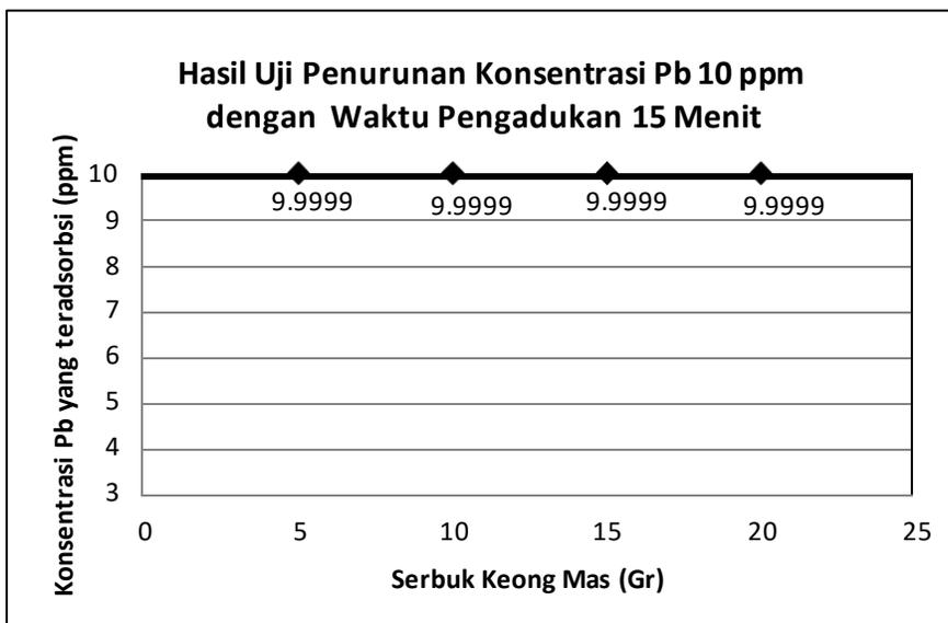
Gambar 1 Hasil Uji Penurunan Pb 10 ppm dengan Waktu Pengadukan 15 Menit
